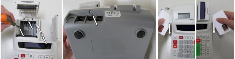
Рисунок 7 – Порядок снятия верхней крышки корпуса
